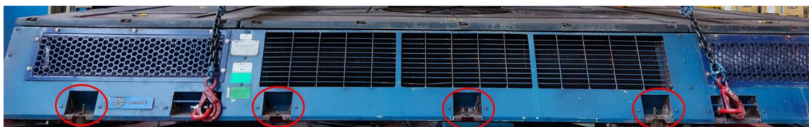
Figura 1. Puntos de sujeción de aires acondicionados.
